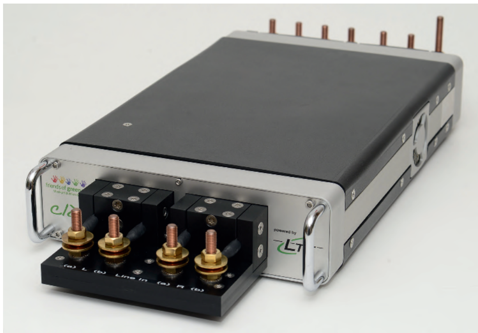
friends of green sonic entwickelte Mitte der 2010er-Jahre in Zusammenarbeit mit dem Unternehmen LTT Labortechnik Tasler einen eigenen Audiorecorder. Der clär-Recorder ermöglicht Aufnahmen im 24 Bit PCM-Verfahren mit einer Abtastrate von 4,2336 MHz. © Peter Heller, friends of green sonic
