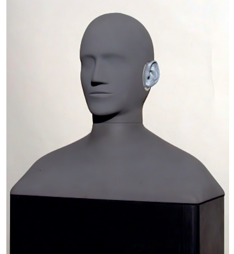
In den 1990er Jahren entwickelte das damalige Institut für Technische Akustik der RWTH Aachen den Kunstkopf HUGO. Grundlage der Arbeiten waren umfangreiche Lokalisationshörtest mit einer großen Anzahl an Testpersonen
