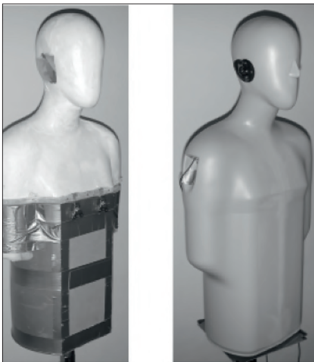
Universität Aalborg (Dänemark): Eine Akustikforschungsguppe entwickelte Ende der 1990er-Jahre den Kunstkopf VALDEMAR, basierend auf Messungen und anthropometrischen Daten
