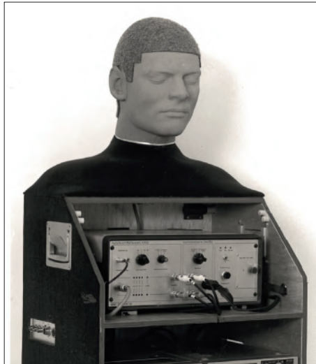
Kunstkopf ‚Made in Aachen I‘: Der HMS I (AachenHead, 1983) des Instituts für Elektrische Nachrichtentechnik der RWTH Aachen begründete eine neue Generation von Kunstköpfen mit deutlich verbesserten technischen Werten © https://www.head-acoustics.com
