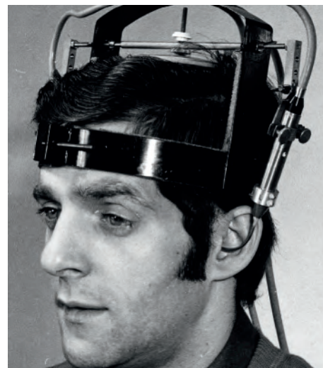
Messaufbau mit Sondenmikrofonen zur Ermittlung der Außenohrübertragungsfunktion bei einer Testperson (1975) © https://soundandscience.net
