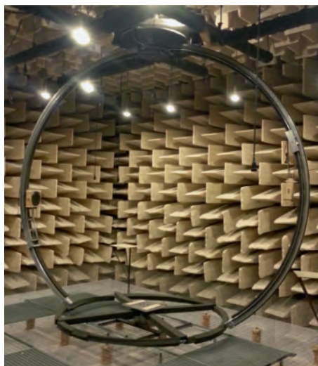
Das TASP-System in der reflexionsarmen Kammer der Universität Oldenburg. Mithilfe eines Drehtisches (horizontale Achse) und eines am Schienensystem geführten Lautsprechers als Schallquelle (vertikale Achse) lassen sich beliebige Schalleinfallrichtungen realisieren © https://uol.de
