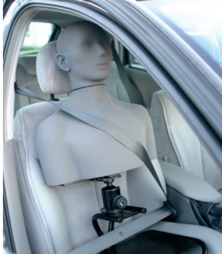
Der Kunstkopf MK2B aus den 1990er-Jahren von Cortex Instruments war für messtechnische Anwendungen konzipiert. Cortex gehört heute zum Hersteller Acoem, der das System jedoch nicht mehr in seinem Portfolio führt © https://www.o1db.com
