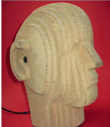
Liefert aufgrund der einfachen Mikrofone und der stark vereinfachten Form lediglich eine mäßige Aufnahmequalität: „Kunstkopf“ D99C von AKG, bekannt als ‚Harry‘ (1973/1974)
