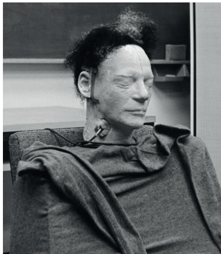
Kunstkopf des Heinrich-Hertz-Instituts der Technischen Universität Berlin, positioniert auf einem Transportkoffer, ca. 1969 © https://soundandscience.net
