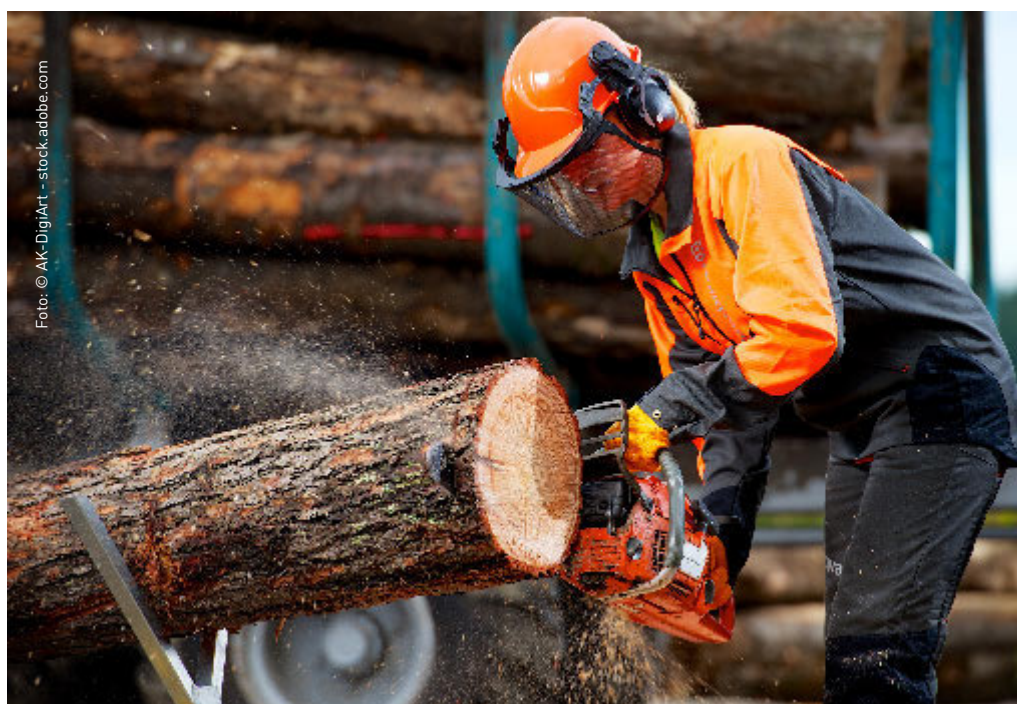
Dass bei Arbeiten mit der Säge Gehörschutz getragen wird, sollte selbstverständlich sein.
